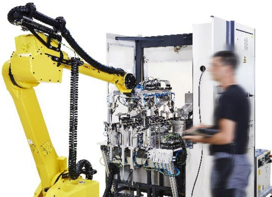
Die auf Kundenwunsch angepasste Handlingzelle X-LOAD eco von ZELTWANGER ermöglicht eine effiziente und präzise Insert-Molding-Bestückung.
