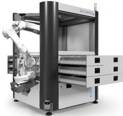
In die X-CELL WB können bis zu vier Wechselgreiferanlagen integriert werden. Es können also mehrere Aufträge automatisch abgearbeitet werden, ohne dass der Greifer von einem Bediener gewechselt werden muss. Ein integrierter Wendegreifer ermöglicht die Bearbeitung der sechsten Seite ohne händisches Umspannen. Die Einfach-, Doppel- und Sondergreifer sind dabei jeweils mit integrierter Blasdüse und Positionsabfrage zur Bauteilerkennung ausgestattet.
